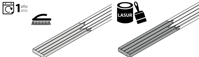
Es necesario aplicar un lasur protector al finalizar la instalación. Es necesario realizar un mantenimiento anual para mejorar la durabilidad de la instalación. Antes de aplicar lasur se recomienda limpiar a presión o pasar un cepillo de alambre para garantizar una buena penetración del producto.
