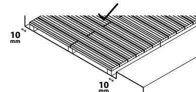
Distribuir las láminas a mataborte con una separación lateral de 7 mm.
