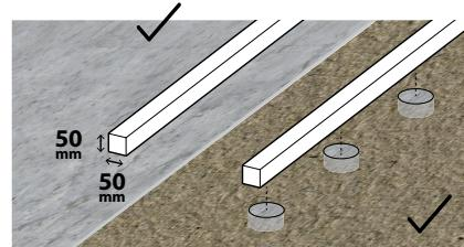
Para prolongar la vida útil da instalación, aplique uma mão de velatura sobre todas as faces antes da instalação.
