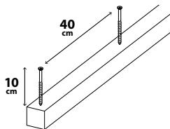
Fijar los rastrelos con tornillos inox o tacos metálicos de largo mínimo 10 cm, con una separación de 40 cm (6 por rastrel).
