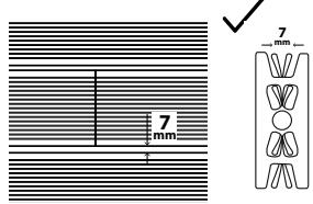
Distribuir las láminas a mataborte con una separación lateral de 7 mm.
