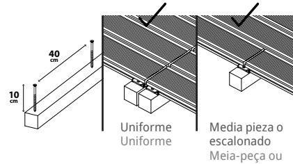
Colocar rastreles sobre solera de hormigón o tierra previamente compactada, disponiendo en este último caso de pivotes de hormigón cada 40-50 cm para fijar los rastrelos.
