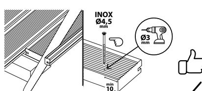
En el caso de que se tenga que cortar la última lama, usar herramientas para madera y fijar con tornillos especiales para madera que sean inoxidables de rosca parcial con aspa ancha y diámetro mayor de 4,5mm. Es recomendable que tengan pretaladrado en caso contrario es necesario taladrar las láminas usando una broca de diámetro igual al diámetro interior del tornillo.
