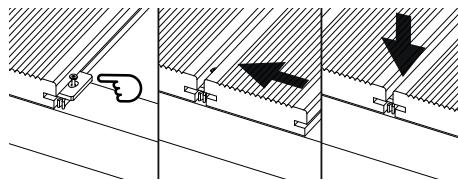
Si la instalación limita con alguna pared o elemento fijo es necesario dejar una separación de 5 mm y atornillar directamente al rastrel. Para garantizar una buena sujeción atornillar la lama en cada cruce con rastrel.
