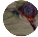
**EXUDACIONES DE RESINA:** La resina es uno de los componentes de la madera que aflora desde el interior de la madera cuando esta se somete a altas temperaturas. Durante el proceso de secado la madera expulsa gran parte del contenido en resina lo que no implica que quede completamente libre de ella y que por tanto pueda volver a aflorar cuando se expone nuevamente a altas temperaturas.
