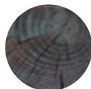
**FENDAS:** Produzem-se geralmente como consequência dos processos de contração e dilatação que a madeira sofre com as variações da temperatura e da humidade. Podem ocorrer mais facilmente em secções maiores, pois a madeira sofre mais durante o processo de secagem.
