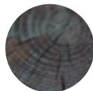
**FENDAS:** Produzem-se geralmente em consequência dos processos de contração e dilatação que a madeira sofre com as variações da temperatura e da humidade. Podem ocorrer mais facilmente em secções maiores, pois a madeira sofre mais durante o processo de secagem.
