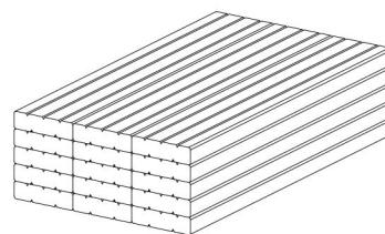
Para mejorar el aspecto de la instalación colocar los tornillos en la canal de la lama para que queden ocultos.
