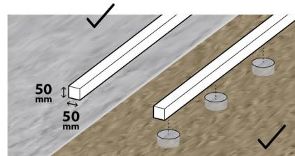
Usar rastrelos de 50x50 sobre solera de hormigón o tierra previamente compactada, disponiendo en este último caso de pivotes de hormigón cada 40-50 cm para fijar los rastrelos.
