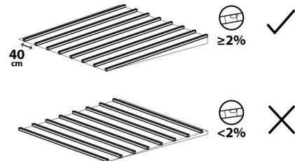
El terreno debe tener una pendiente mínima del 2% para facilitar la evacuación de agua y así evitar las acumulaciones sobre la superficie de la tarima. Los rastrelos se colocarán paralelos a la línea de pendiente del terreno para evitar estancamiento de agua y separados entre sí 40 cm.
