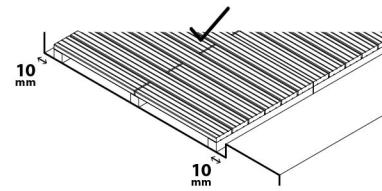
Si la instalación limita con alguna pared o elemento fijo es necesario dejar una separación de 10 mm.
