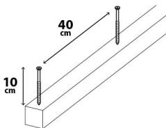
Fijar los rastrelos con tornillos o tacos metálicos de largo mínimo 10 cm, con una separación de 40 cm (6 por rastrel).
