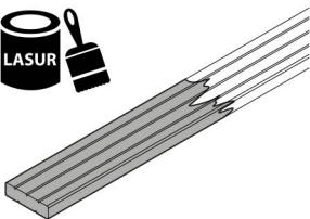
Es necesario aplicar un lasur protector al finalizar la instalación. Es necesario realizar un mantenimiento anual para mejorar la durabilidad de la instalación. Antes de aplicar lasur se recomienda limpiar a presión o pasar un cepillo de alambre para garantizar una buena penetración del producto.
