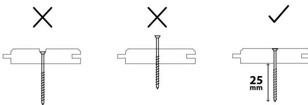
La longitud del tirafondo ha de ser igual a la suma del espesor de los perfiles + 25mm para garantizar una buena fijación al rastrel. También se recomienda que los tirafondos tengan avellanador para garantizar que queden bien enrasados con la superficie de la madera. No atornillar en los nudos de la madera.
