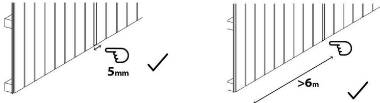
Los perfiles de fachada que dispongan de machihembrado longitudinal se deben montar y ajustar con la mano sin apretar las piezas entre sí. Además, se debe ir ganando una holgura de aproximadamente 4-5mm por cada metro lineal de instalación en sentido perpendicular a la fibra para favorecer los posibles movimientos de la madera derivados de la hincha-zón y merma ocasionadas por la humedad.
