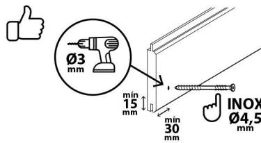
Usar tirafundos especiais para madera de acero inoxidable y con doble rosca para realizar una fijación óptima de los perfiles de fachada. Los tirafundos deben ser autoperforantes y con un diámetro mínimo de 4,5mm. Es recomendable, especialmente en las fijaciones próximas a los extremos de los perfiles, taladrar las piezas con una broca de diámetro igual al diámetro interior del tirafundo.
