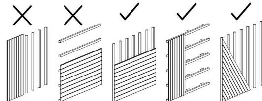
En función del efecto que busquemos podemos colocar los perfiles de fachada en al menos tres esquemas diferentes. Colocar los rastrellos en sentido perpendicular a la distribución de los perfiles. En el caso de enrasrelados horizontales, estos se deben separar de la pared mediante unos tacos de rastrel de al menos 100mm de largo y separados entre sí 500mm. Esto permitirá una correcta ventilación de la fachada por su parte posterior.
