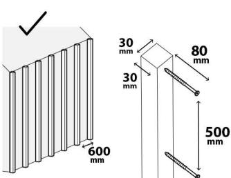
Colocar rastrelos de 30x30mm separados entre sí como máximo a 600mm. Fijar los rastrelos con tornillos o tacos mecánicos de largo mínimo 80mm y separados cada 500mm.
