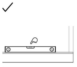
Para la instalación de los primeros perfiles de fachada, tanto en posición horizontal como en vertical, se recomienda el uso de un nivel ya que estas piezas servirán de guía para el resto de la instalación.
