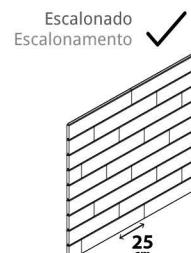
Em esquemas horizontais para evitar que el agua se quede estancada en la canal de la hembra debemos colocar siempre el macho hacia arriba.
