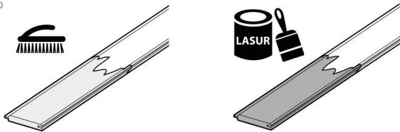
Los intervalos de mantenimiento varían en función de las características de la instalación: ubicación, exposición, producto protector utilizado, etc. Antes de la aplicación de cualquier producto protector se debe de limpiar la superficie de madera de forma adecuada. Para más información consulta nuestro ThermoPine Handbook.
