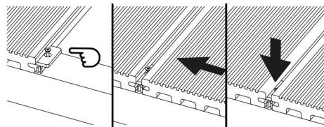
Si la instalación limita con alguna pared o elemento fijo es necesario dejar una separación de 5 mm y empezar colocando la grapa de inicio. Para garantizar una buena sujeción se debe montar una grapa en cada rastrel. Nos casos em que a instalación confronta com uma parede ou elemento fijo, deve garantir-se uma distância de 5 mm e começar por colocar os grampos desde o inicio. Para asegurar uma boa fixação, deverá ser colocado um grampo em cada ripa.
