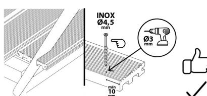
En el caso de que se tenga que cortar la última lámina, usar herramientas para madera y fijar con tornillos especiales para madera que sean inoxidables de rosca parcial con aspa ancha y diámetro mayor de 4,5mm. Es recomendable que tengan pretaladrado en caso contrario es necesario taladrar las láminas usando una broca de diámetro igual al diámetro interior del tornillo.
