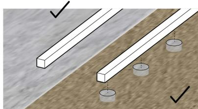
Colocar rastreles sobre solera de hormigón o tierra previamente compactada, disponiendo en este último caso de pivotes de hormigón cada 40-50 cm para fijar los rastreles.
