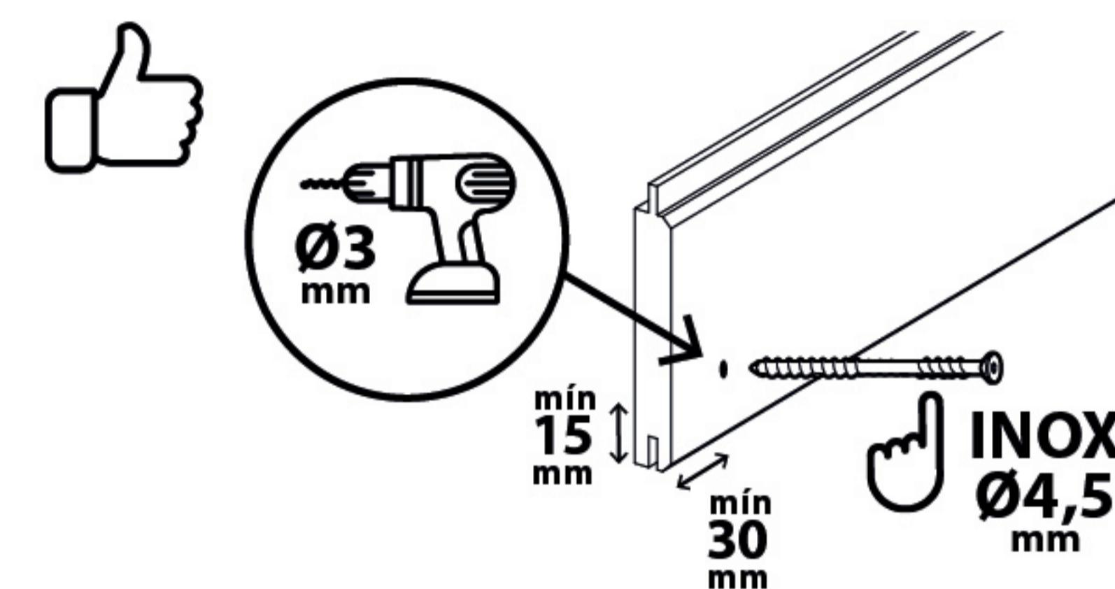
Usar tirafondos especiais para madeira de acero inoxidável y con doble rosca para realizar una fijación óptima de los perfiles de fachada. Los tirafondos deben ser autoperforantes y con un diámetro mínimo de 4,5mm. Es recomendable, especialmente en las fijaciones próximas a los extremos de los perfiles, taladrar las piezas con una broca de diámetro igual al diámetro interior del tirafondo.
