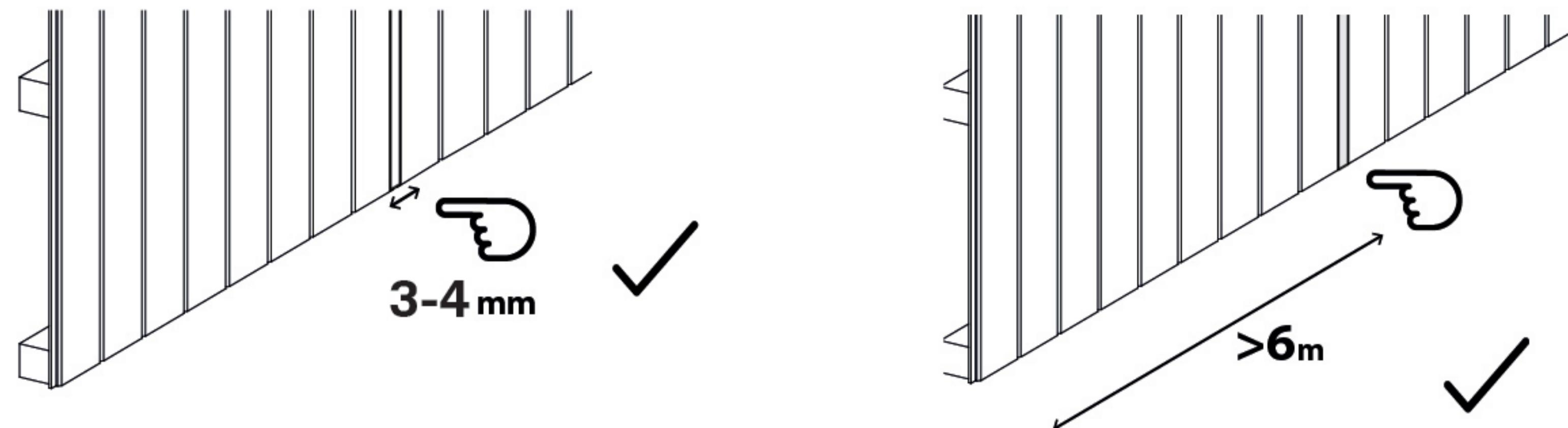
Los perfiles de fachada que dispongan de machiembraido longitudinal se deben montar y ajustar con la mano sin apretar las piezas entre sí. Además, se debe ir ganando una holgura de aproximadamente 3-4mm en cada pieza en sentido perpendicular a la fibra para favorecer los posibles movimientos de la madera derivados de la hinchação y merma ocasionadas por la humedad.
