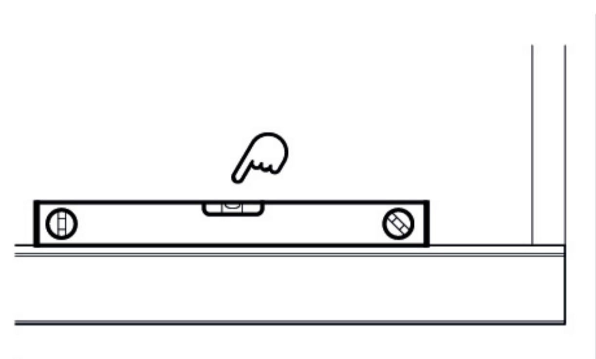
Para la instalación de los primeros perfiles de fachada, tanto en posición horizontal como en vertical, se recomienda el uso de un nivel ya que estas piezas servirán de guía para el resto de la instalación.
