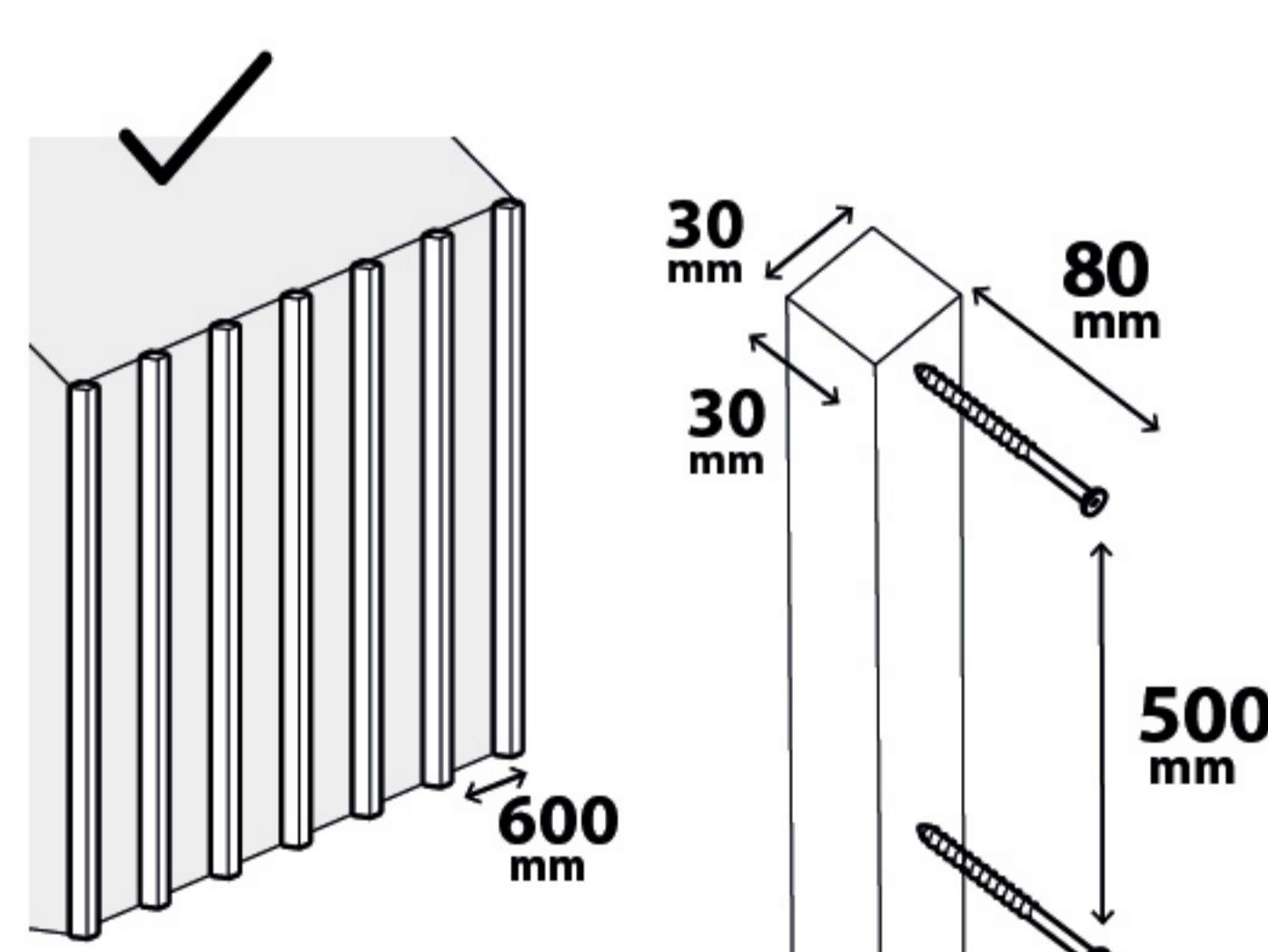
Colocar rastrelos de 30x30mm separados entre sí como máximo a 600mm. Fijar los rastrelos con tornillos o tacos mecánicos de largo mínimo 80mm y separados cada 500mm.
