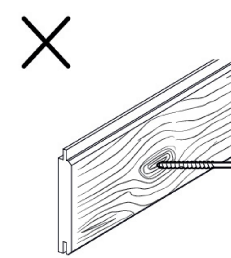
La longitud del tirafondo ha de ser igual a la suma del espesor de los perfiles + 25mm para garantizar una buena fijación al rastrel. También se recomienda que los tirafondos tengan avellanador para garantizar que queden bien enrasados con la superficie de la madera. No atornillar en los nudos de la madera.
