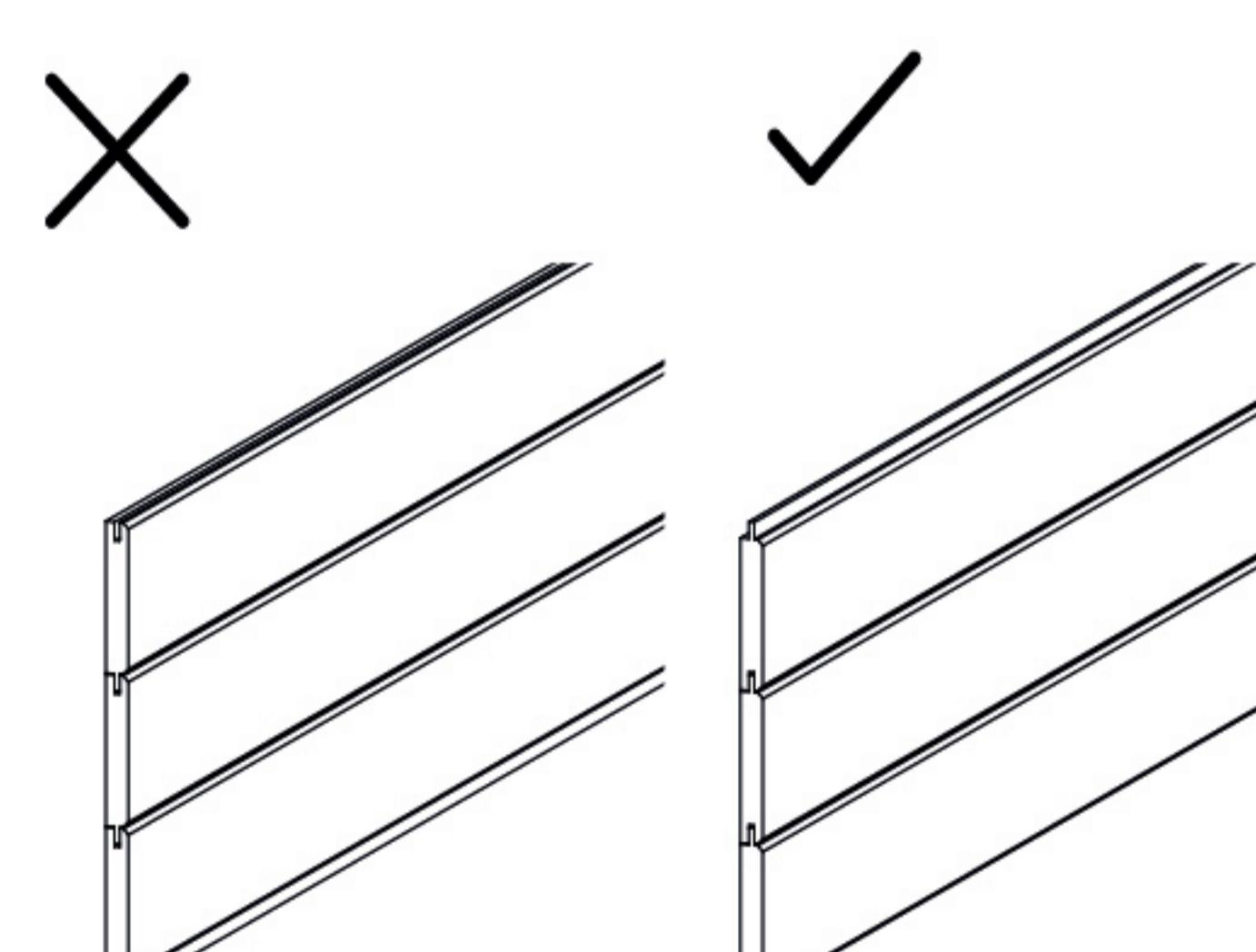
En esquemas horizontais para evitar que el agua se quede estancada en la canal de la hembra debemos colocar siempre el macho hacia arriba.
