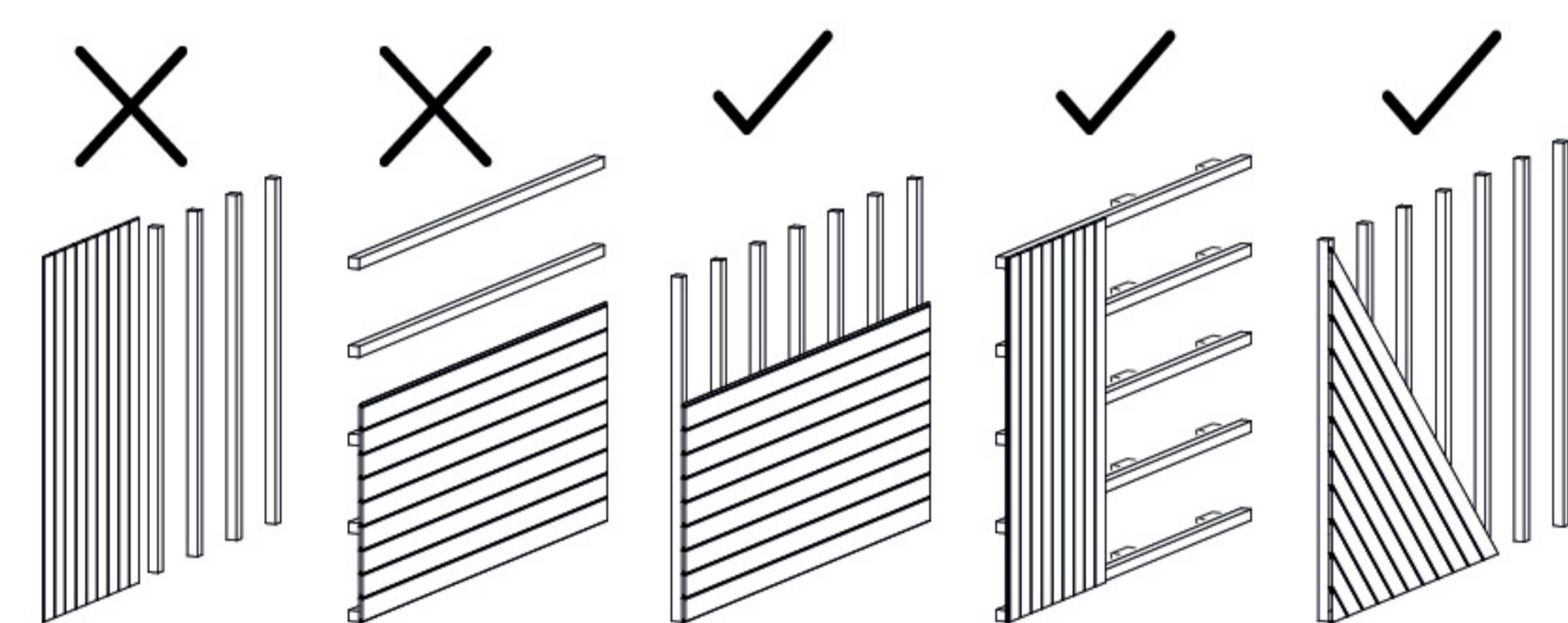
En función del efecto que busquemos podemos colocar los perfiles de fachada en al menos tres esquemas diferentes. Colocar los rastrellos en sentido perpendicular a la distribución de los perfiles. En el caso de enrasrelados horizontales, estos se deben separar de la pared mediante unos tacos de rastrel de al menos 100mm de largo y separados entre sí 500mm. Esto permitirá una correcta ventilación de la fachada por su parte posterior.
