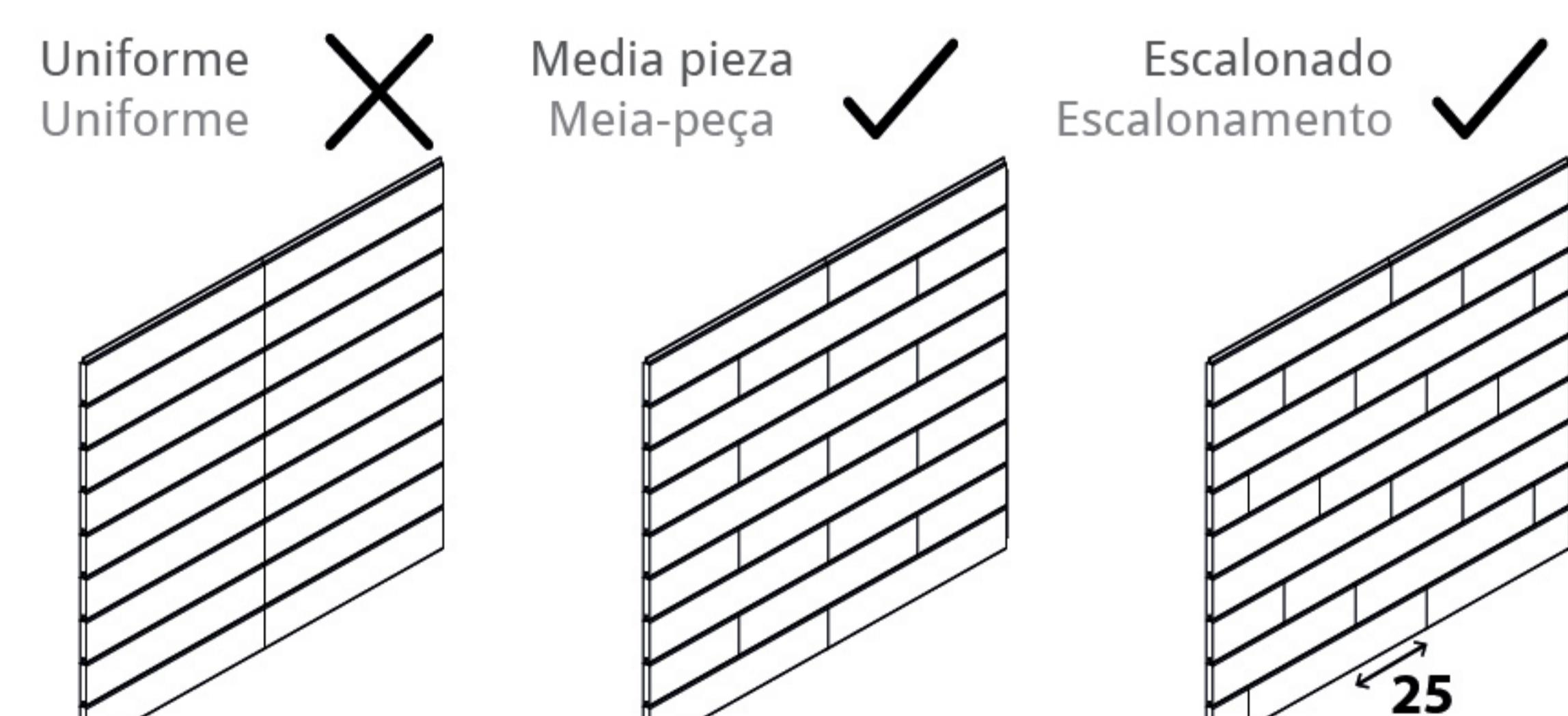
Em esquemas horizontais, para evitar que a água fique retida no rasgo da fêmea, devemos sempre colocar o macho voltado para cima.
