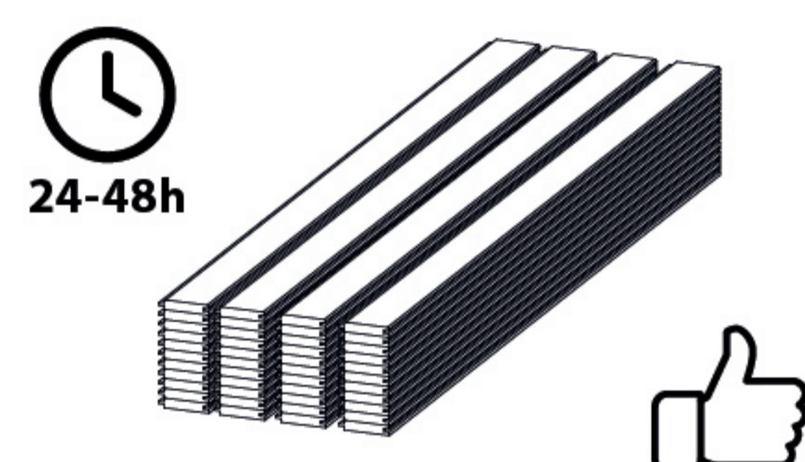
Antes de la instalación, se aconseja que los perfiles de fachada se acondicionen hasta la humedad de equilibrio higroscópico de la zona. Recomendamos dejar los perfiles en el lugar de la instalación durante 24-48 horas, para ello, colocar la madera en una superficie plana con el embalaje original hasta el momento de la instalación. Proteger el material de la lluvia y el sol.
