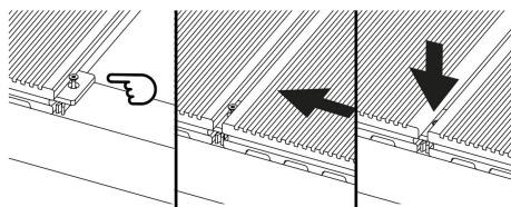
Si la instalación limita con alguna pared o elemento fijo es necesario dejar una separación de 5 mm y empezar colocando la grapa de inicio. Para garantizar una buena sujeción se debe montar una grapa en cada rastrel. Nos casos em que a instalação confronta com uma parede ou elemento fixo, deve garantir-se uma distância de 5 mm e começar por colocar os grampos desde o início. Para assegurar uma boa fixação, deverá ser colocado um grampo em cada ripa.
