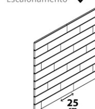
Colocar rastreles de 30X30mm separados entre sí como máximo a 600mm. Fijar los rastrelos con tornillos o tacos mecánicos de largo mínimo 80mm y separados cada 500mm.
