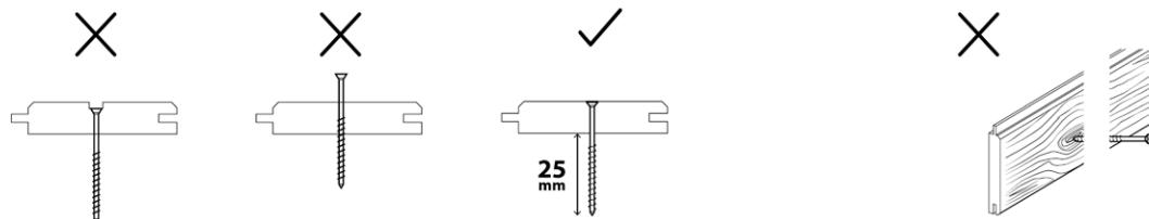
La longitud del tirañón ha de ser igual a la suma del espesor de los perfiles + 25mm para garantizar una buena fijación al rastrel. También se recomienda que los tirañones tengan avellanador para garantizar que queden bien enrasados con la superficie de la madera. No atornillar en los nudos de la madera.
