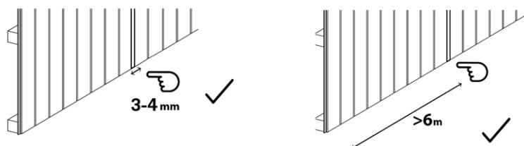
Los perfiles de fachada que dispongan de machiembraido longitudinal se deben montar y ajustar con la mano sin apretar las piezas entre sí. Además, se debe ir ganando una holgura de aproximadamente 3-4mm en cada pieza en sentido perpendicular a la fibra para favorecer los posibles movimientos de la madera derivados de la hinchaçon y merma ocasionadas por la humedad.
