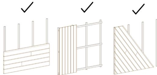
En función del efecto que busquemos podemos colocar los perfiles de fachada en al menos tres esquemas diferentes. Colocar los rastreles en sentido perpendicular a la distribución de los perfiles. En el caso de instalaciones verticales de los perfiles de fachada, se deben instalar dos órdenes de rastrel, el primero en vertical y el segundo en horizontal. Esto permitirá una correcta ventilación de la fachada por su parte posterior.
