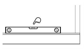
Para la instalación de los primeros perfiles de fachada, tanto en posición horizontal como en vertical, se recomienda el uso de un nivel ya que estas piezas servirán de guía para el resto de la instalación.
